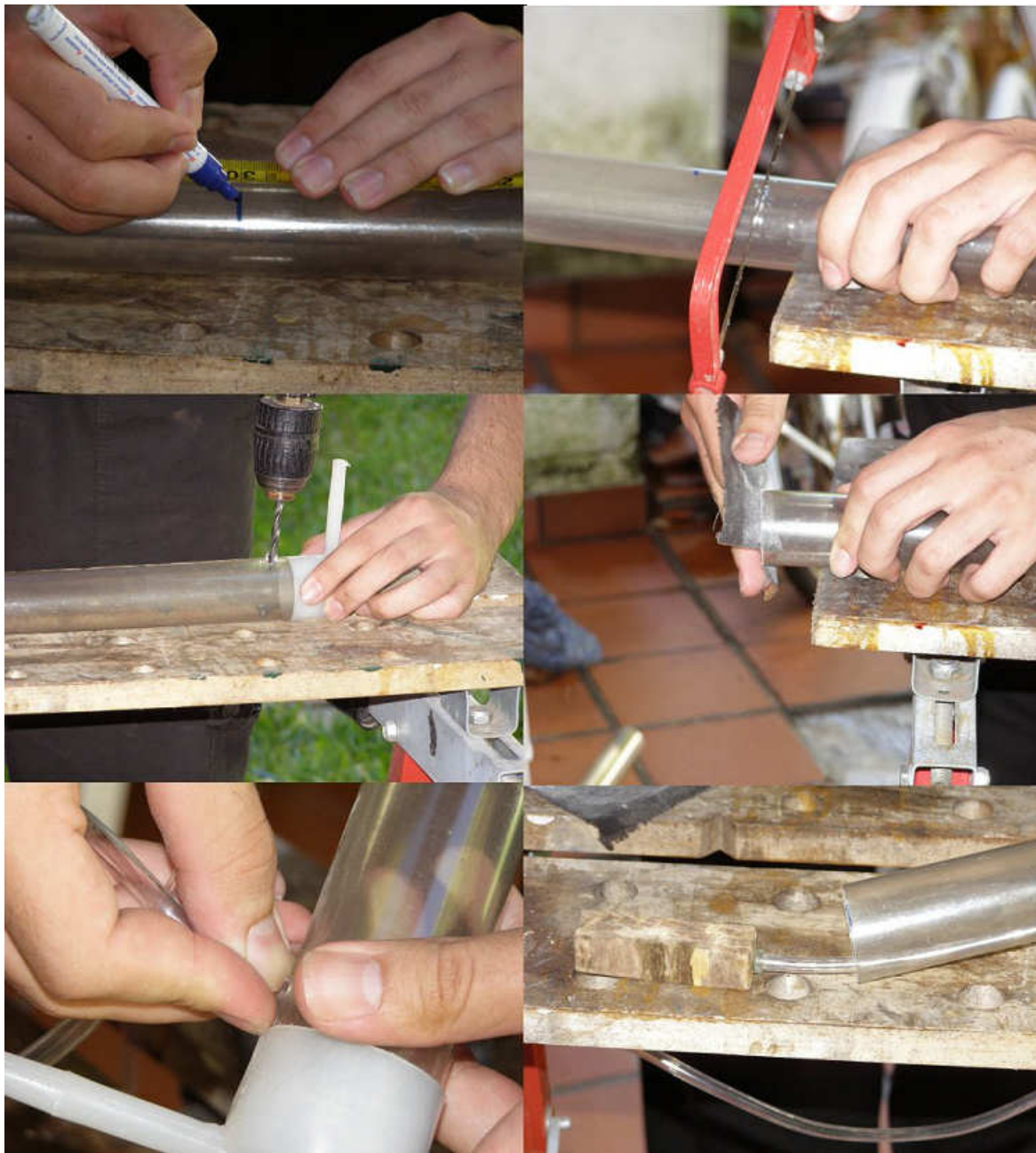
Figura 2: Pasos realizados para la construcción del reactor
