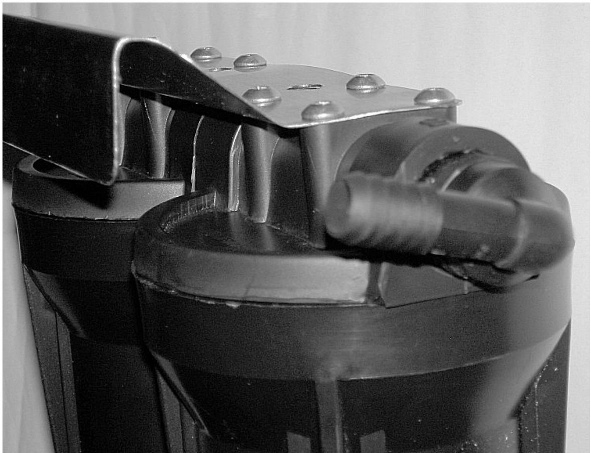
Figura 4: Vista lateral de la chapa que otorga rigidez y fijación a los soportes. Ya están instalados los conectores acodados para manguera.
