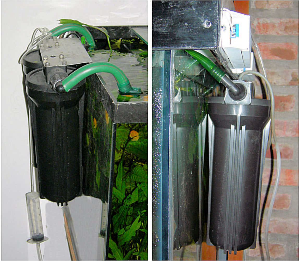
Figura 9: Dos prototipos distintos montados en el lateral del acuario. En el de la izquierda, dos tubos rígidos de polipropileno fueron moldeados con calor para darle forma a los conductos de admisión y salida, mientras que en el caso de la derecha se utilizó manguera normal de acuarios para conectar la admisión y la salida del filtro. Se ha decidido el montaje lateral al acuario para facilitar el acceso para limpieza y minimizar el espacio necesario. Notar en ambos casos el inreso de CO 2 en el primero soporte.
