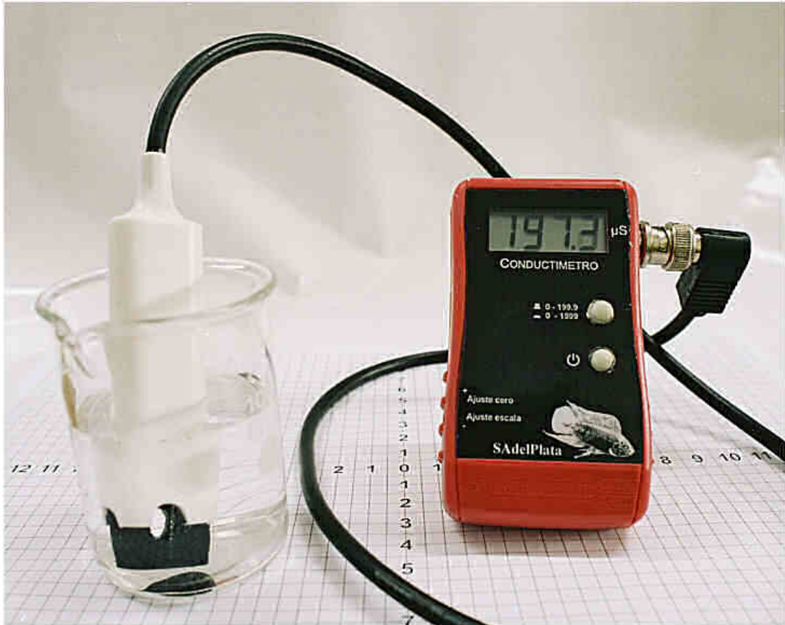
Figura 6: Vista final del conductímetro usando una de las celdas descritas en la parte III de este artículo.
