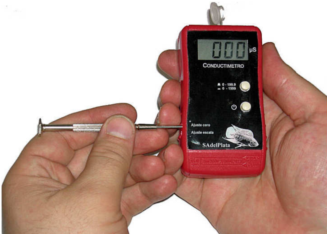
Figura 5: Ajuste del cero del conductímetro mediante un destornillador apropiado.
